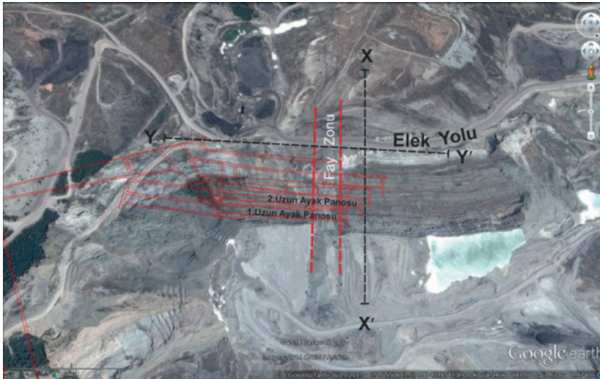
Şekil 3b. Ana fay zonu, elek yolu ve eski harman sahasının konumsal ilişkileri (X-X': Kömür damarını dikine kesen kesitin izi-Phase 2 yazılımıyla analizi yapılmıştır, Y-Y': Elek yoluna paralel alınan kesitin izi).
