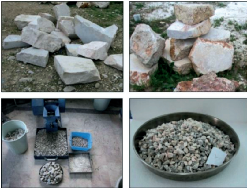
Şekil 3. Ocaklardan alınan blok numuneler ve hazırlanan agregalar.
